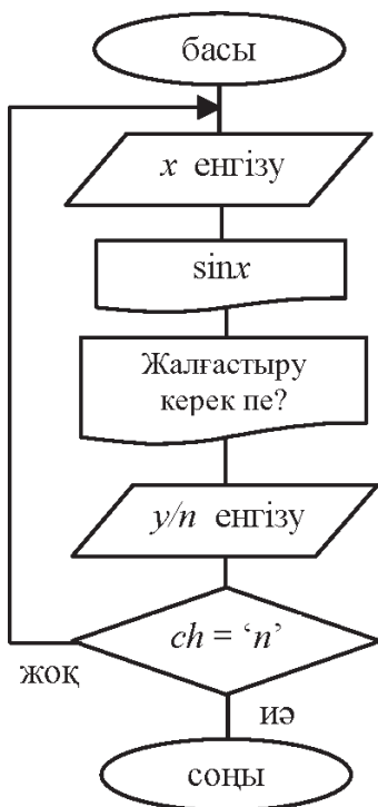
5.6-сурет. Функция мәнін есептеу алгоритмінің схемасы
